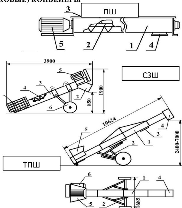
Имеем возможность изготовления шнековых транспортеров следующих типоразмеров витков:
